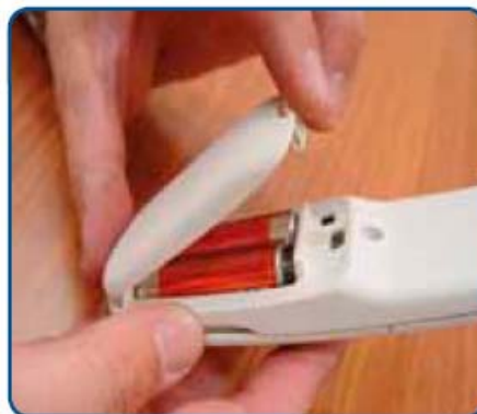
Rys. 4.1: Wymiana baterii w kasecie przywołań
