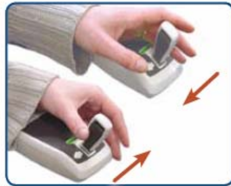
Rys. 2.18: Trzymaj joystick w pożądanym kierunku jazdy
